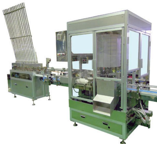
従来の回転位置決めストロー貼り付け装置に、ロボットによる小袋投入機能を付与したシステムです。画像認識により、ロボットが小袋を吸着し、搬送ラインの容器などにすばやく運搬、商品の味に変化もたらず小袋やオマケを添えるといった高付加価値製品の生産性向上に寄与します。
